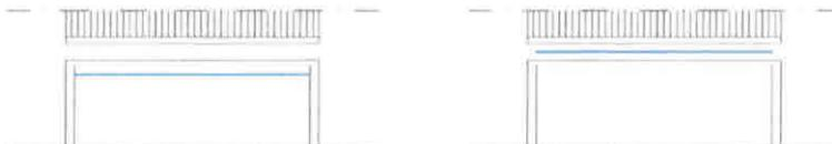
O comprimento do toldo não deverá exceder a largura do vão e deverá ser instalado no seu interior
