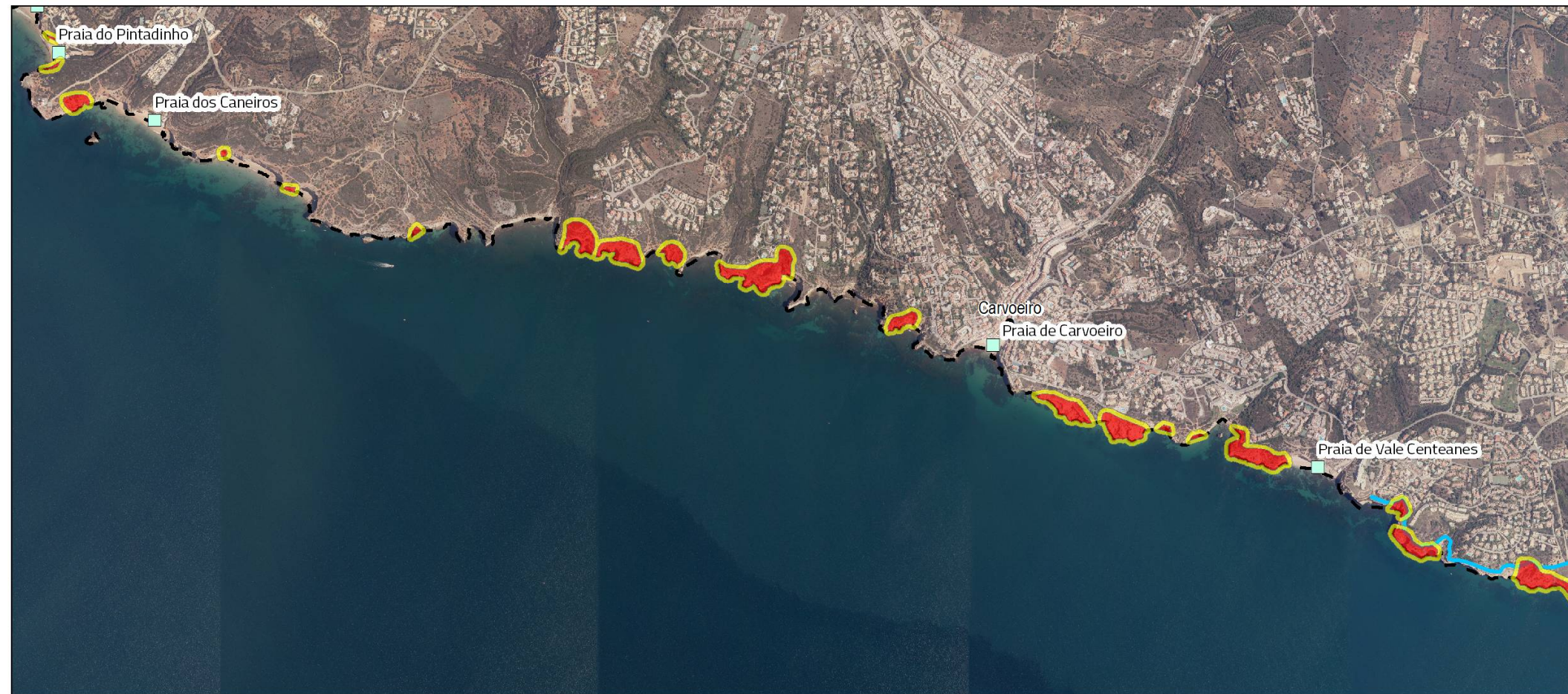
Figura VII.2.14. Perigosidade no topo das arribas
