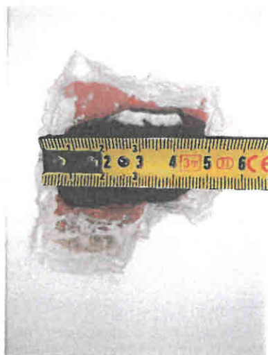
Fotografias n.º 18 e 19 - Dimensões do orifício por medição com fita métrica
